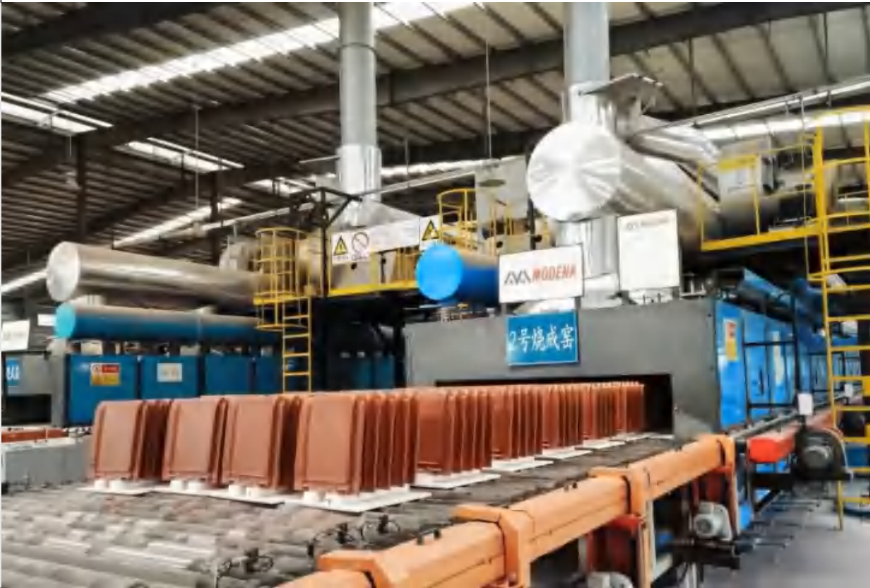
Customer: 嘉泰屋面材料（肇庆）有限公司 | JIATAI ROOFING MATERIALS (ZHAOQING) CO., LTD. Project: Extruding Roof Tile Production Line Equipment supplied: Firing Kiln mod.MRK , 5-Layer Dryer mod.MRD-HB5 Product and output: 355x345MM ; 50,000pcs/D 工程内容: 挤出平西瓦生产线 主要使用设备: MOD. MRK烧成窑炉, MOD. MRD-HB 五层干燥 产品类型及产量: 355 X345 MM; 日产50,000片
