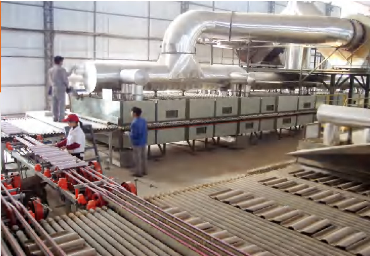
Customer: 江西太阳陶瓷有限公司 | JIANGXI TAIYANG CERAMICS CO., LTD. Project: Ceramic Roof Tile Production Line Equipment supplied: Firing Kiln mod.MGE , 2-Layer Dryer mod.MRD-HB2 Product and output: 70,000pcs/D 工程内容: 西瓦生产线 主要使用设备: MOD. MGE 烧成窑炉, MOD. MRD-HB 两层干燥 产品类型及产量: 日产70,000片
