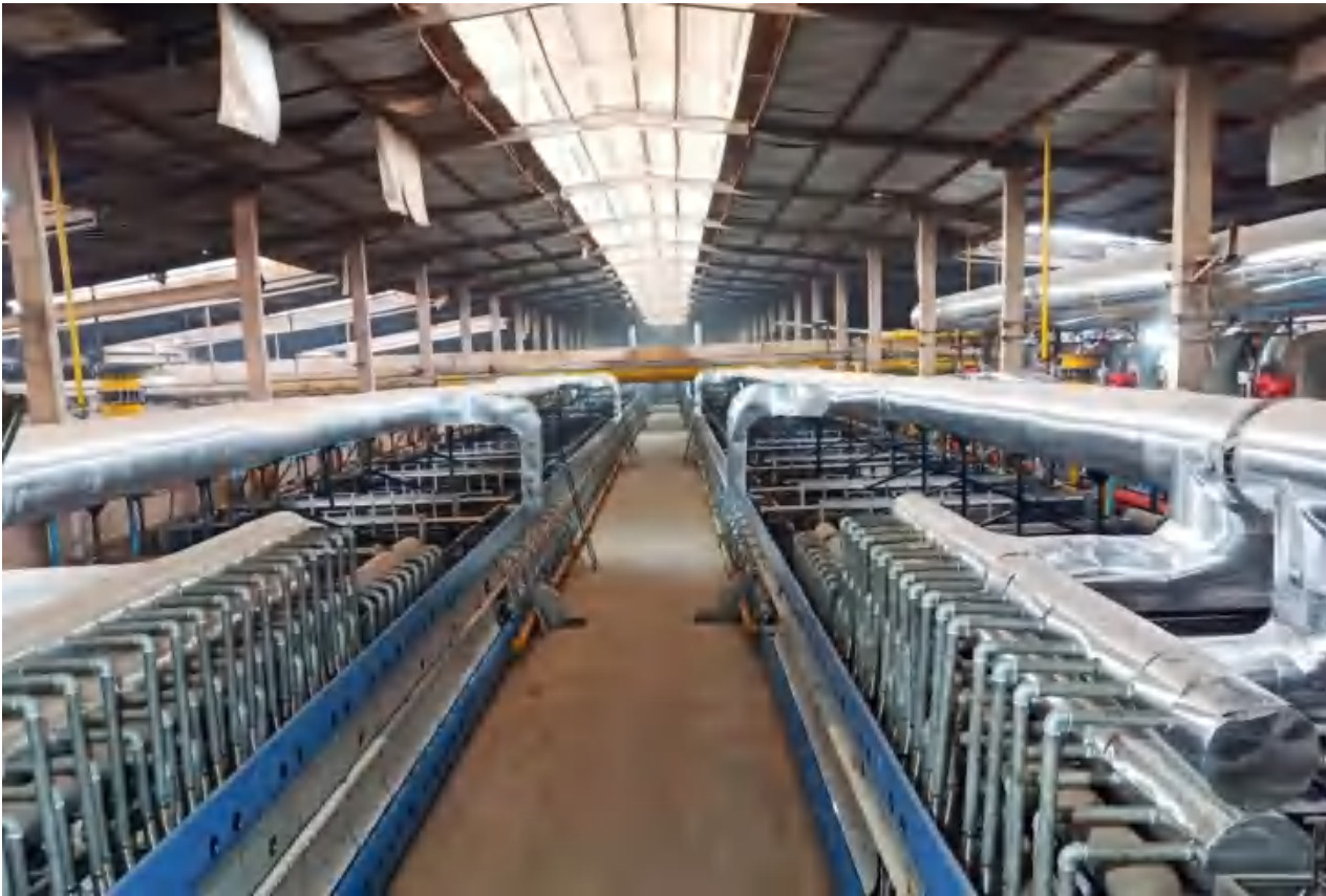
Customer: TOKO VIETNAM CO., LTD Project: Glazed Roof Tiles Equipment supplied: 6-Layer Dryer mod.MRD-IG6 Product and output: 14x215x355MM; 6,000sqm/D 工程内容: 屋顶西瓦 主要使用设备: MOD. MRD-IG 六层干燥窑 产品类型及产量: 14 X 215 X 355MM; 日产6,000平方米
